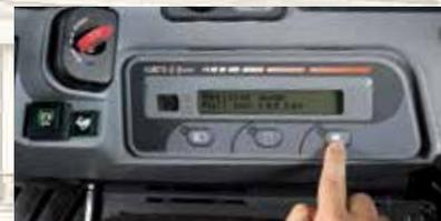
1 Insérez la clé Rouge d'enregistrement, puis pressez le bouton sur le tableau de bord.
