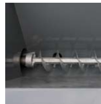
Grâce à l'arbre à cardan enfiché, le remplacement du rotor et du stator est un jeu d'enfants.
